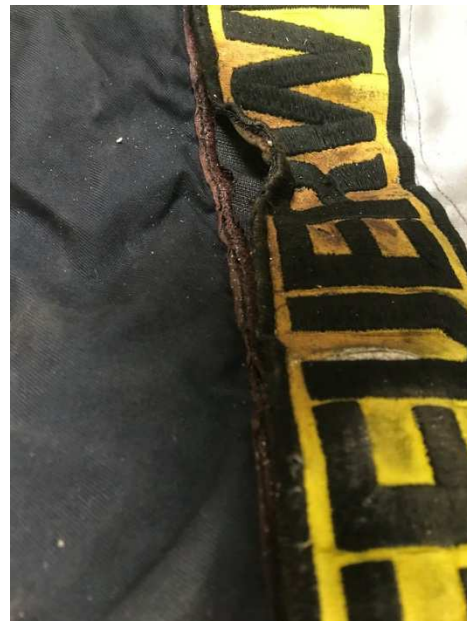
Abbildung 14 - Durch thermische Einflüsse beschädigte Brandschutzkleidung
