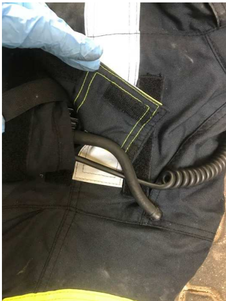
Abbildung 13 - Die erhebliche Wärmeeinwirkung lässt sich auch an der durch Wärmeeinwirkung verbogenen Antenne erkennen
