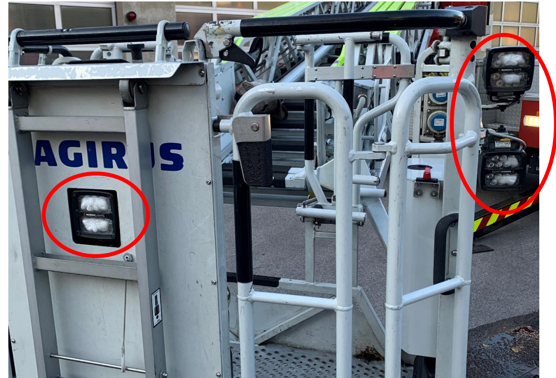
Beschädigungen durch Wärmestrahlung am Korb der Drehleiter
