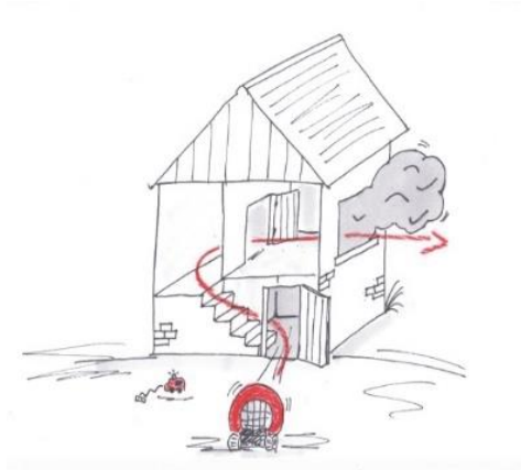
Abbildung 1 Der Ventilationskanal ist der Weg von der Zuluftöffnung bis zur Abluftöffnung, durch den Frischluft vom Lüfter gedrückt wird.[IdF NRW]
