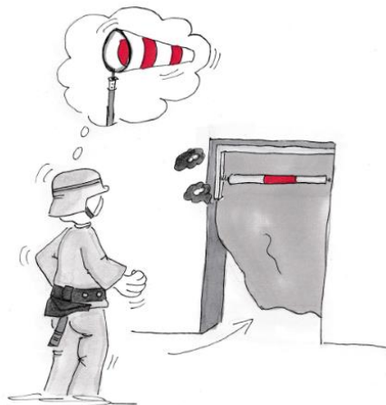
Abbildung 4 Mobiler Rauchverschluss – Rückfallebene und Strömungsanzeiger. [IdF NRW]
