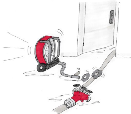
Abbildung 5 Lüfter in Bereitstellung – 90° gedreht zur Zuluftöffnung und der Motor läuft im Standgas. [IdF NRW]
