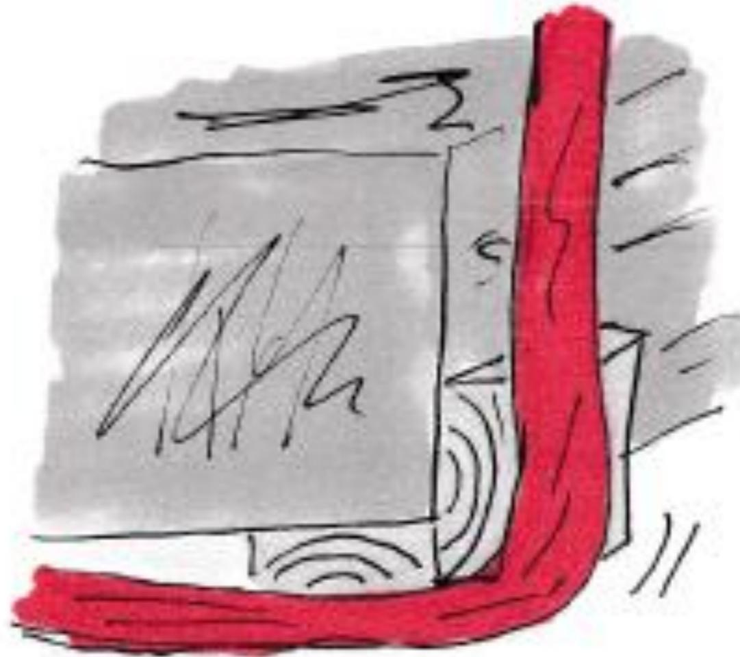
Schütze die Rundschlinge an der Kante durch den Einsatz von Formholz, Decken oder dem vorhandenen Kantenschutz.
