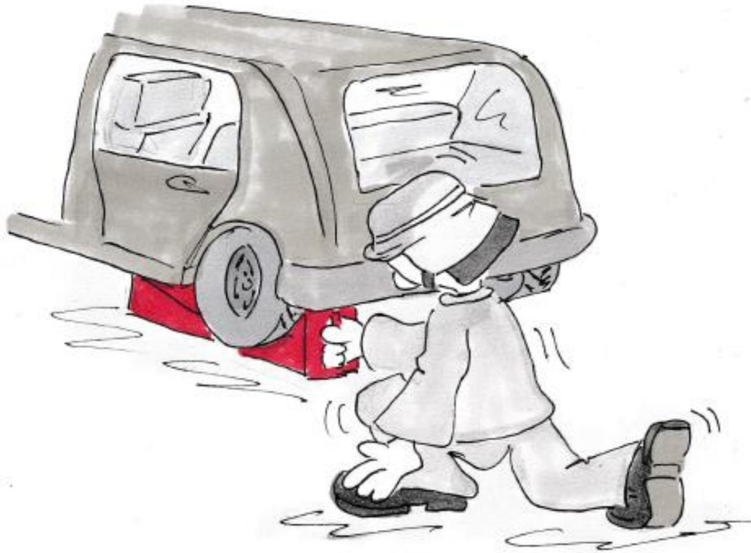
Sicherung mit Radkeilen an der starren Hinterachse in beide Rollrichtungen.
