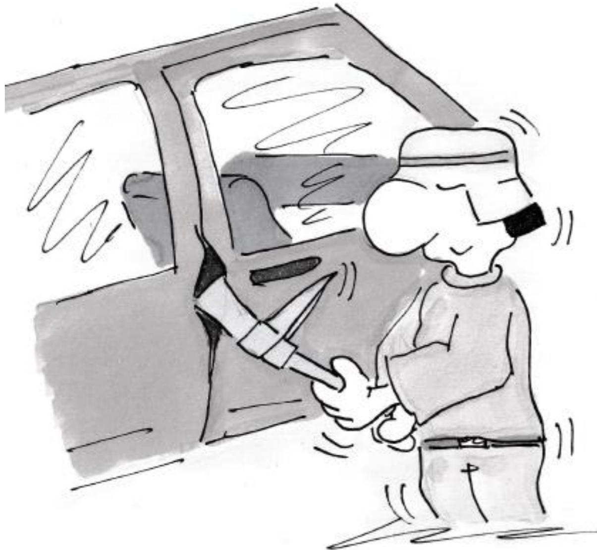
Das Multifunktionswerkzeug wird mit der keilförmigen Klinge in den Türspalt gedrückt und dann gedreht. Wird ein kleiner Spalt geschaffen, dann kann dieser mittels Holzkeil gesichert und erweitert werden.
