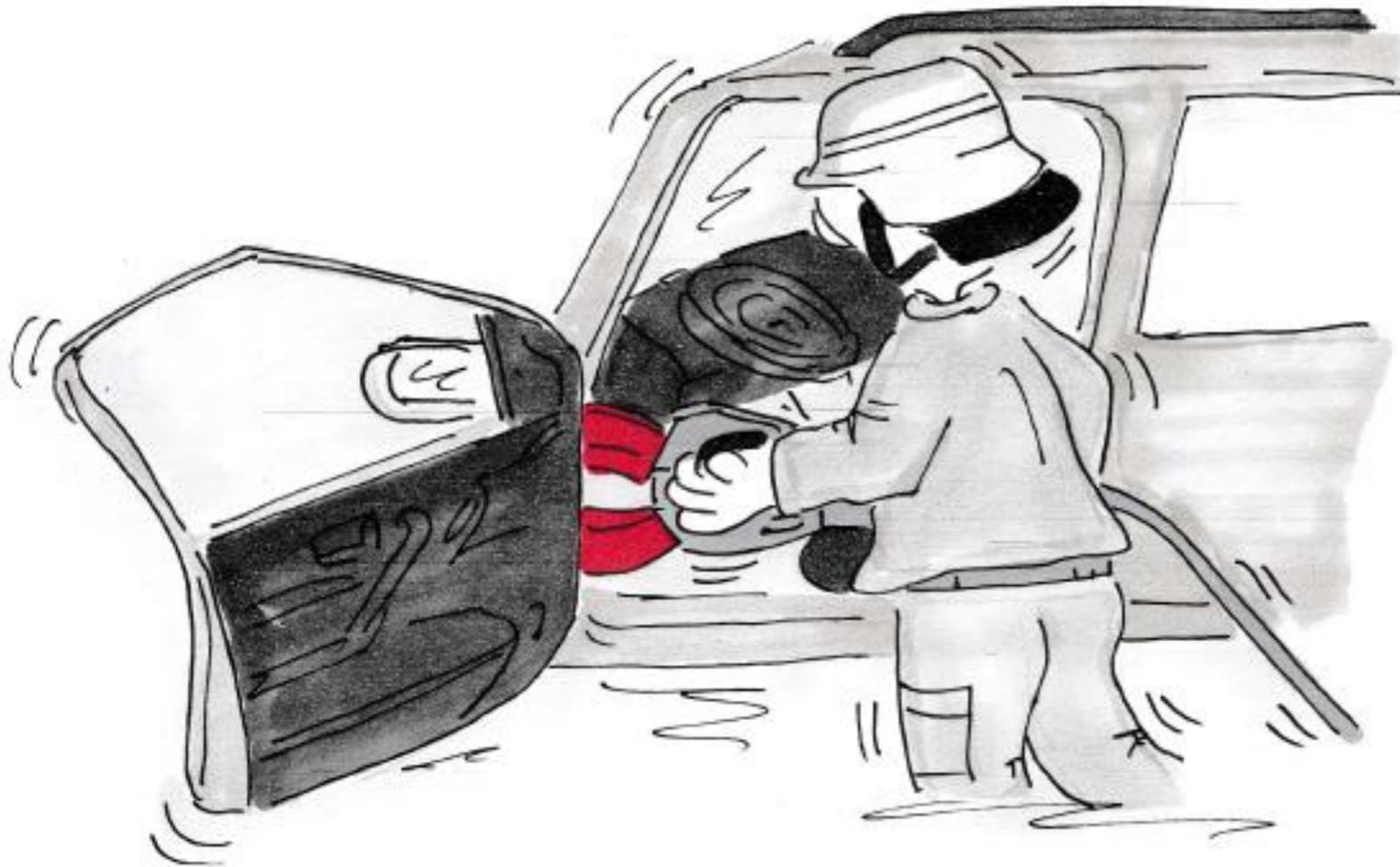
Tür entfernen durch das Schneiden oder Reißen der Türscharniere.
