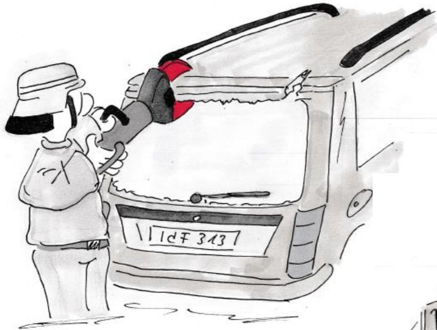
2 Schnitte mit der Schere in das Dach.
