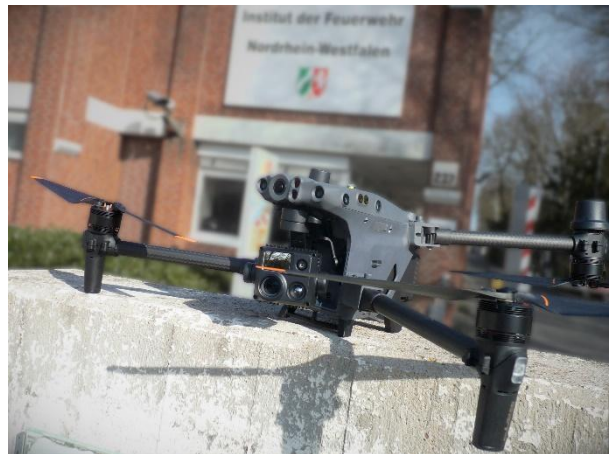
Abbildung 1: Für den BOS-Einsatz geeignete Drohne mit Wärmebildkamera [IdF NRW, 2023]
