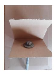
Befestige eine Gewindestange mit Mutter und Unterlegscheibe an einer doppellagigen und stabilen Pappe.
