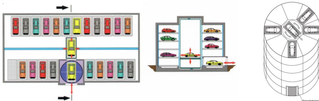
Bild 8: Parkregal mit Dreheinrichtung in der Übergabekabine (links [1]), Parkzylinder (rechts) [8].
