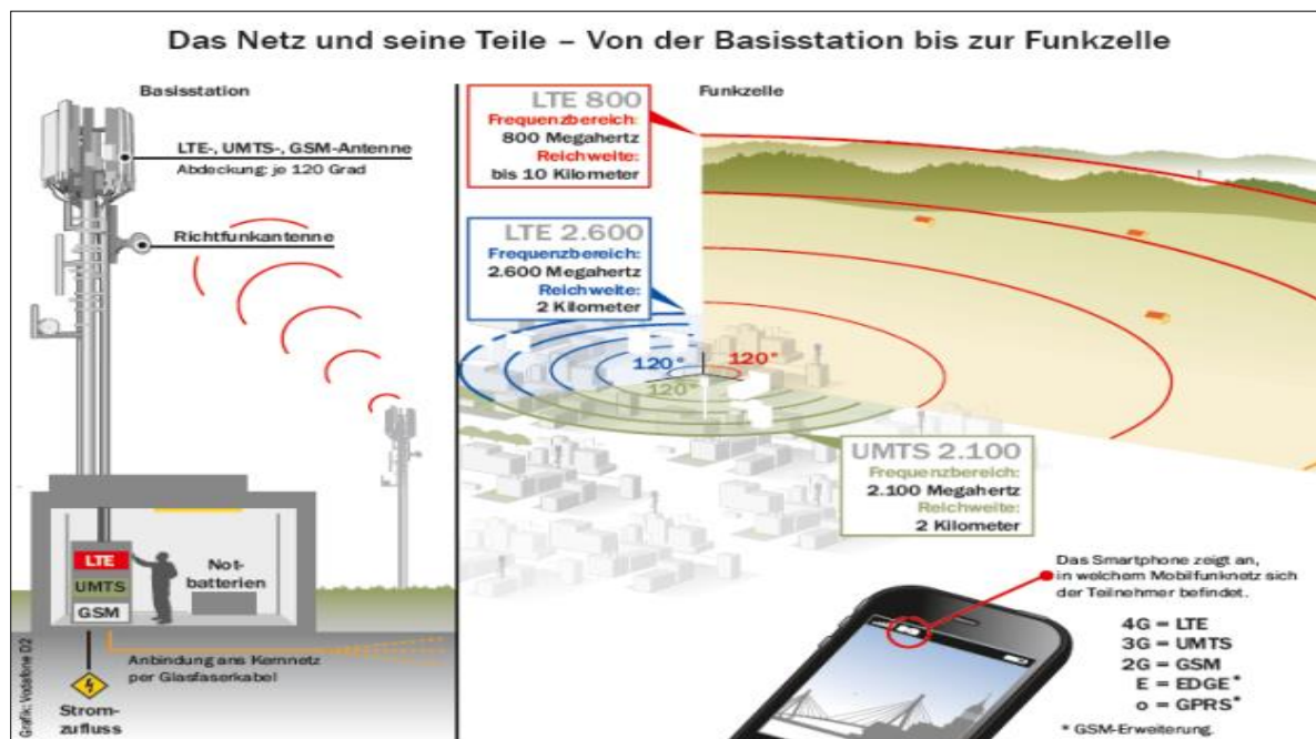
Abbildung 5: Mobilfunkzellen (Quelle Elektronik Kompendium)
