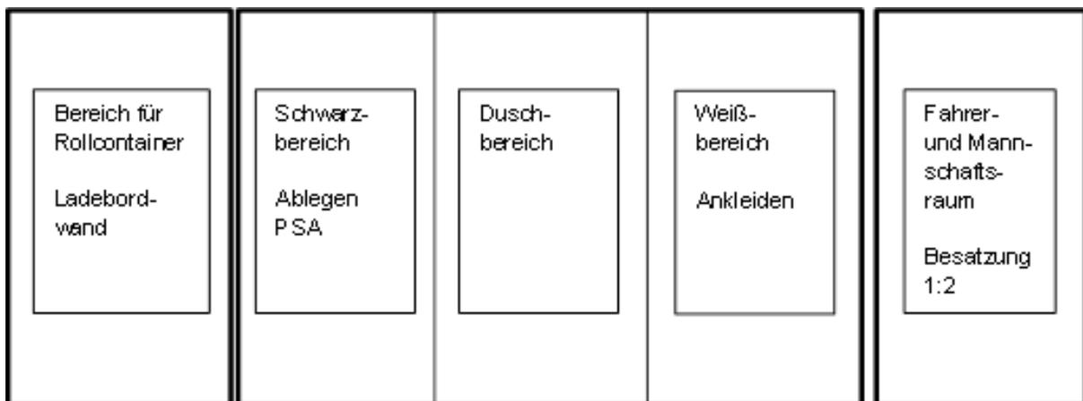
**Abbildung 3: Grobgliederung des universalen Dekon-Fahrzeuges**
