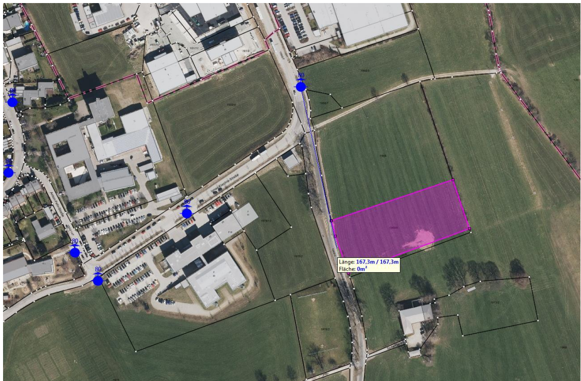
Abbildung 5: Eingblendete Hydranten auf einem Orthophoto / Einsatz von Mess- und Zeichenwerkzeuge im GIS (eigene Darstellung, generiert mit dem Programm „RIWA-GIS“).
