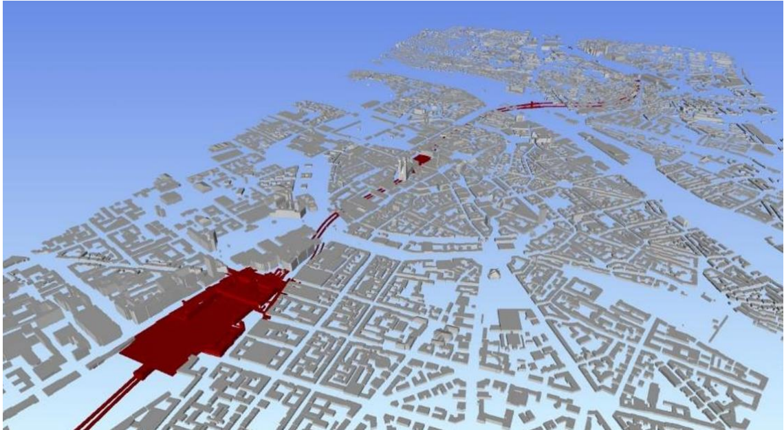
Abbildung 8: 3D-Stadtmodell der Innenstadt von München kombiniert mit dem Planungsmodell der zweiten S-Bahn-Stammstrecke, links der Hauptbahnhof samt der notwendigen Erweiterungen; Quelle: (Bormann et.al., 2015)
