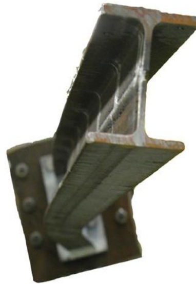
Bild: Biegedrillknicken eines Stahlträgers
