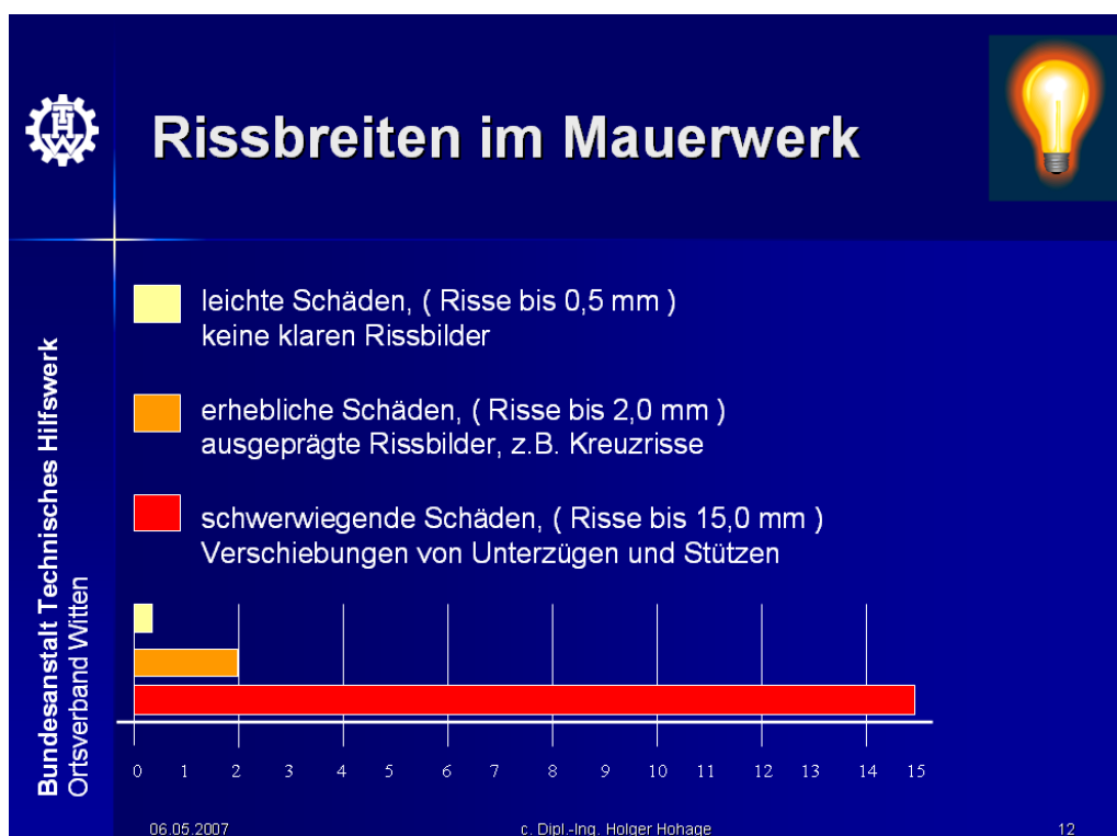
Zulässige und kritische Rissbreite im Mauerwerk
