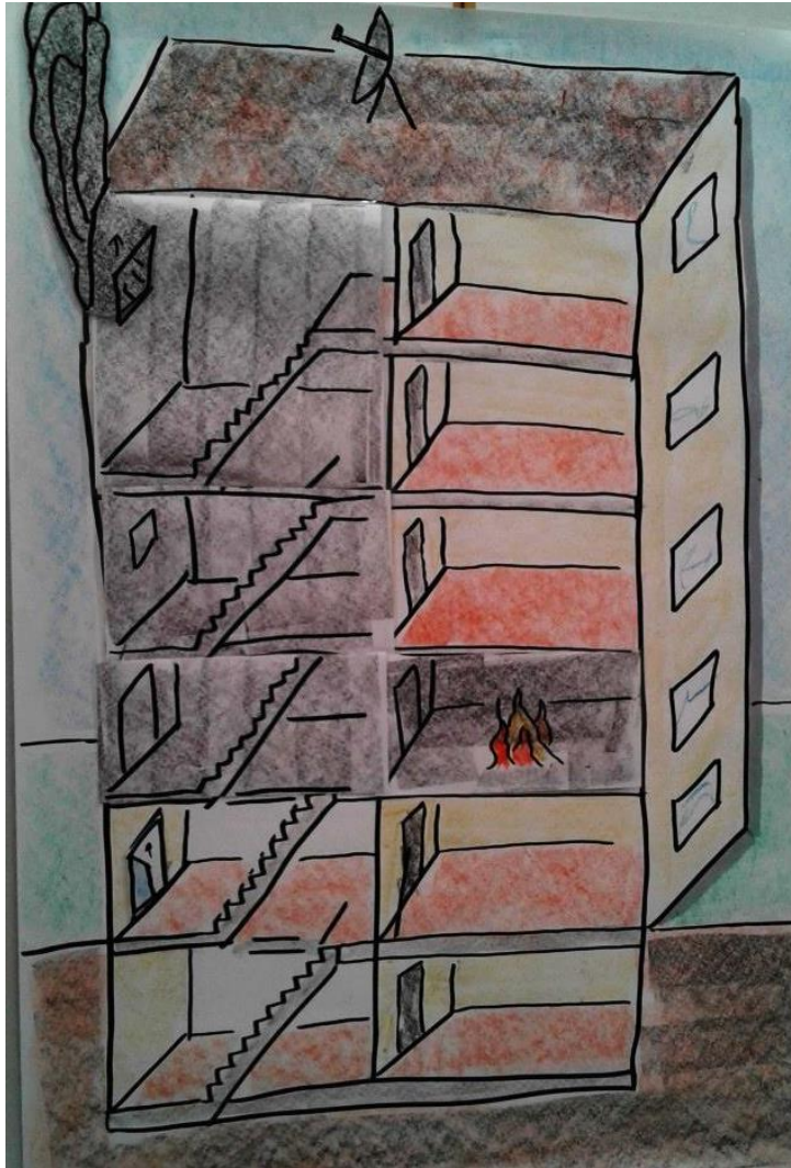
Abbildung 6: Verrauchter Treppenraum mit Abluft
