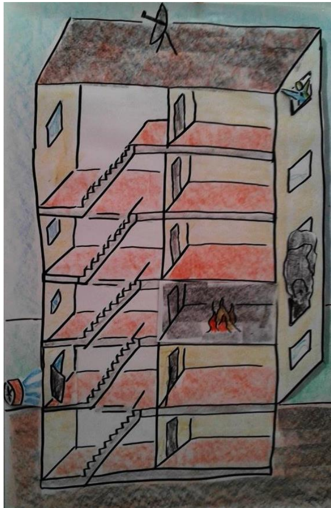
Abbildung 4: Wohnungsbrand 1. OG mit Lüfter
