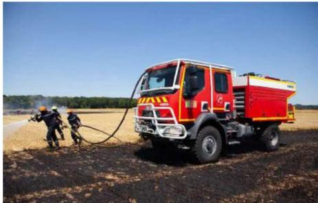
Abbildung 3: Waldbrand Tanklöschfahrzeug bei der bodengebundenen Brandbekämpfung
