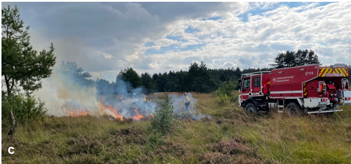
Abbildung 4.3: Tanklöschfahrzeug „Wald“ – CCFM 3000 Niedersachsen im Gelände. a , b und c zeigen das niedersächsische Katastrophenschutz Fahrzeug, welches nach dem Abbild der französischen mittleren Waldbrand-Tanklöschfahrzeuge CCFM in Anlehnung an die Fachempfehlung Waldbrand-TLF der AGBF Bund beschafft wurde. Fotos und Bildrechte: a, b und c: Heiko Bieniuša, Kreispressereferent Kreisfeuerwehrverband Lüchow-Dannenberg e.V., c: Max Scholz, Waldbrandteam e.V..
