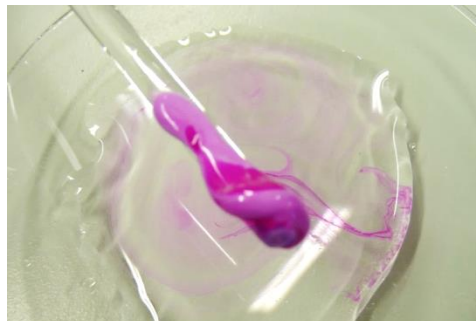
Abbildung 55: Nachweis von Wasser in einer unbekanntem Flüssigkeit durch deutliche rosa Verfärbung der Paste [Bild: IdF NRW]
