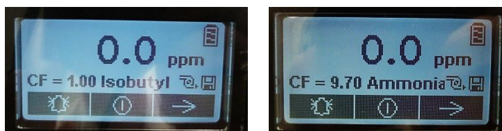
Abbildung 43: Displayanzeige mineRAE 3000 für Isobuten (Korrekturfaktor = 1) und Ammoniak (Korrekturfaktor = 9,70) [Bilder: IdF NRW]
