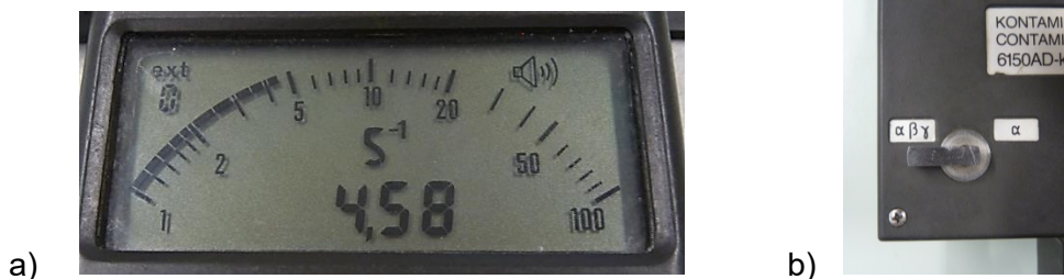
Abbildung 15: Anzeige Kontaminationsmonitor Fa. automess mit der Anzeige "ext0" für das Flächenzählrohr in der Einheit \text{s}^{-1} (a) mit der Schalterstellung „ \alpha\beta\gamma “ (b) [Bild: IdF NRW]
