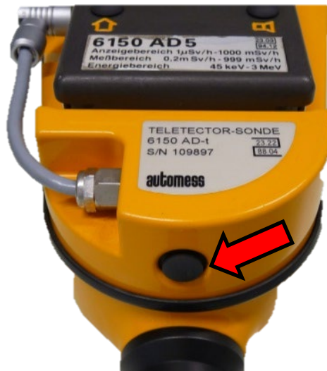
Abbildung 10: Umschalttaste (roter Pfeil) zwischen Sonde und Basisgeräte [Bild: IdF NRW]
