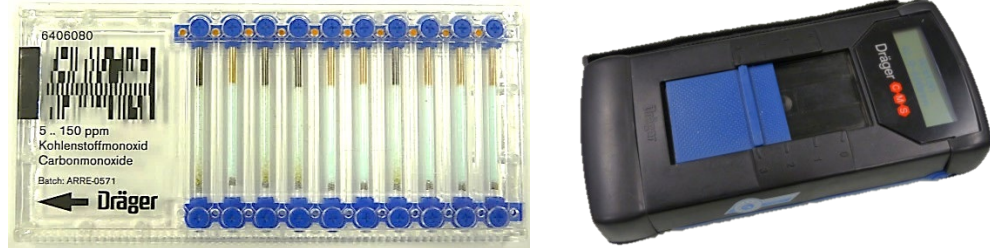
Abbildung 32: Chip-Messsystem CMS mit Chip „Kohlenstoffmonoxid 5 – 150 ppm“ und Analyser (Fa. Dräger) [Bilder: IdF NRW]
