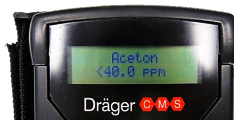
Abbildung 33: Anzeige: Messergebnis für eine Konzentration von 0 ppm Aceton. Messbereich des Chips 40 - 600 ppm [Bild: IdF NRW]
