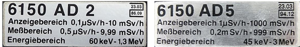
Abbildung 8: Angaben von Anzeige-, Mess- und Energiebereich eines Dosisleistungsmessgerätes AD2 und 5 Fa. automess [Bilder: IdF NRW]
