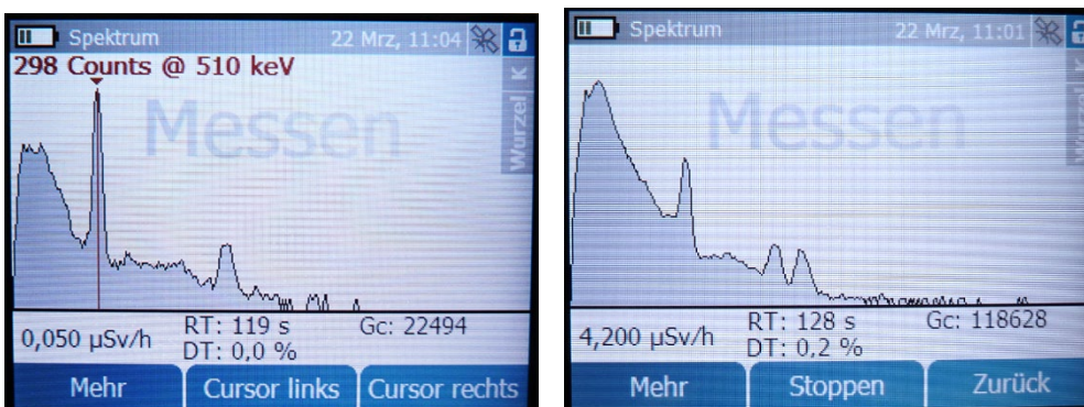
Abbildung 23: Energieverteilung zweier künstlicher Strahlenquellen mit typischen Peaks gemessen mit dem identIFINDER2 [Bild: IdF NRW]
