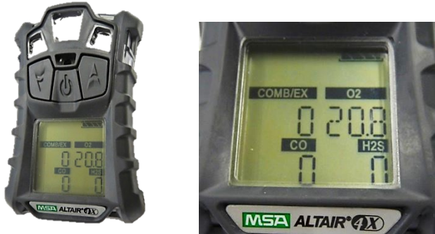
Abbildung 39: Mehrgasmessgerät ALTAIR mit 4 Sensoren [Bilder: IdF NRW]
