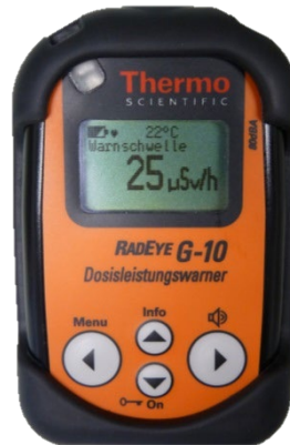
Abbildung 11: Dosisleistungswarner mit der Warnschwelle von 25 \mu\text{Sv/h} Fa. Thermo [Bild: IdF NRW]
