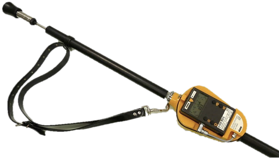
Abbildung 9: Teleskop-Sonde Fa. automess mit abnehmbarer Kappe zum Messen von \beta -Strahlung [Bild: IdF NRW]
