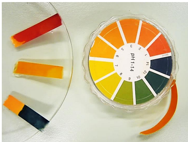
Abbildung 53: Universalindikatorpapier mit der Skala pH 1-14. Drei benetzte Papierstreifen (von oben) mit einer Säure (pH <1), einer neutralen Lösung (pH 7) und einer Lauge (pH 14). [Bild: IdF NRW]
