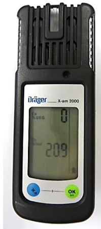
Abbildung 38: Explosionswarngerät X-am 2000 mit Ex-Sensor und Sauerstoffsensor Fa. Dräger [Bild: IdF NRW]
