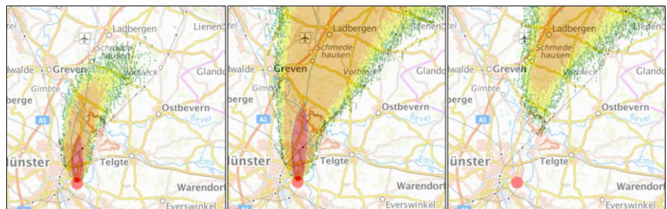
Abbildung 16: Ausbreitungsprognose NAR des DWD für den Stoff Brom für den Zeitraum von 30 min, 90 min, und 180 min. [Bild: IdF NRW]
