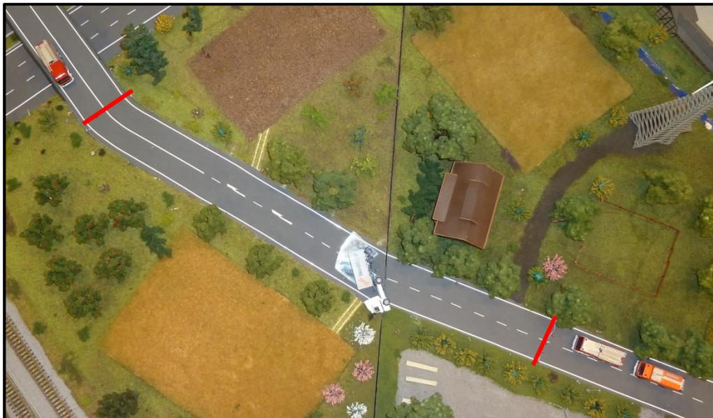
Abbildung 10: Beispiel einer Kennzeichnung des Gefahrenbereiches bei einem VU auf einer Landstr. [IdF NRW]
