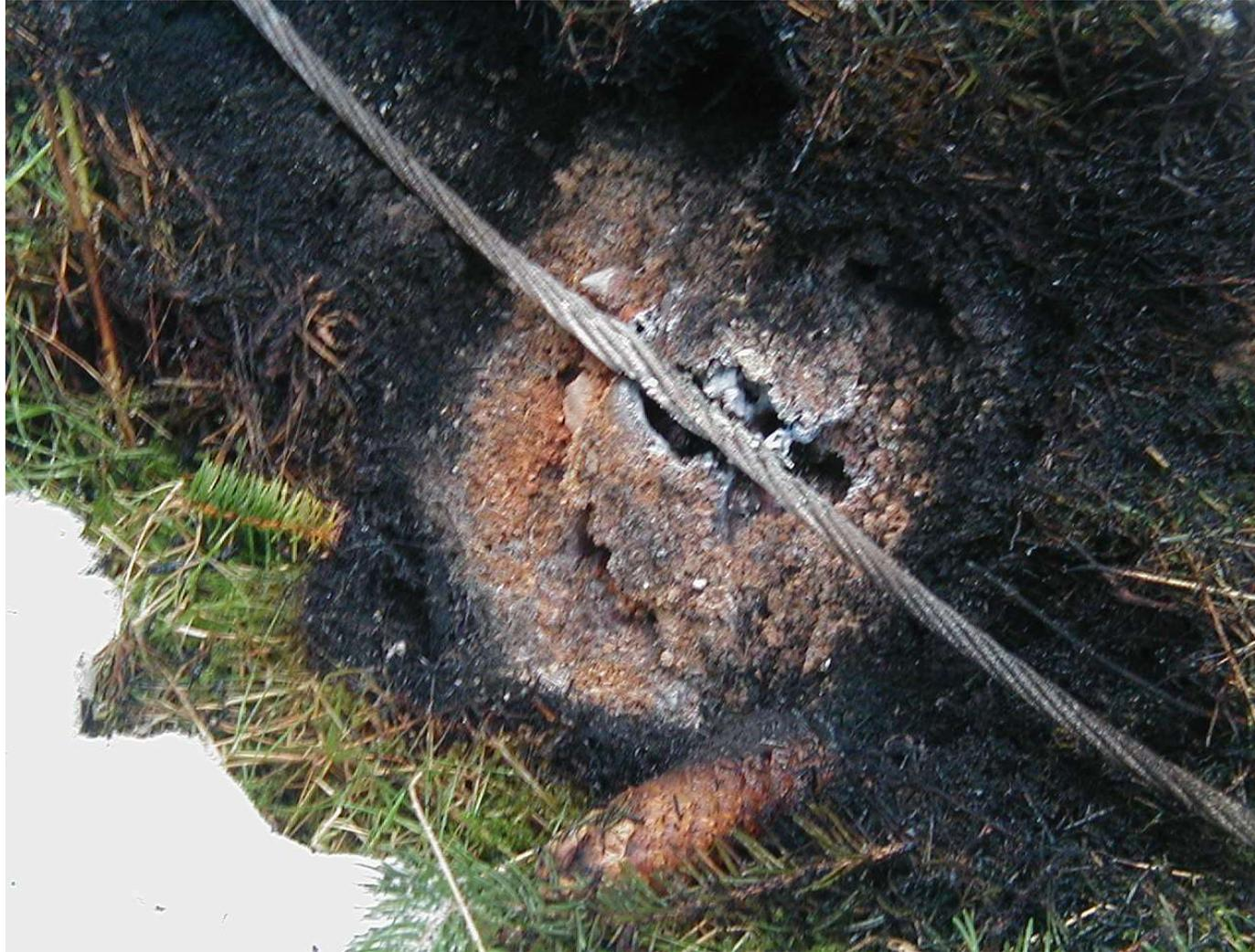
**Achtung, ein Seil auf dem Boden „Spannungstrichter“ Gefahr!**
