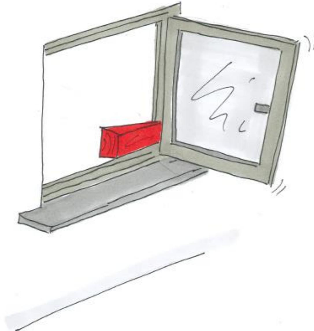
damit Lüftungsmaßnahmen durchgeführt werden können. Sichert die Abluftöffnung gegen Zuschlagen.
