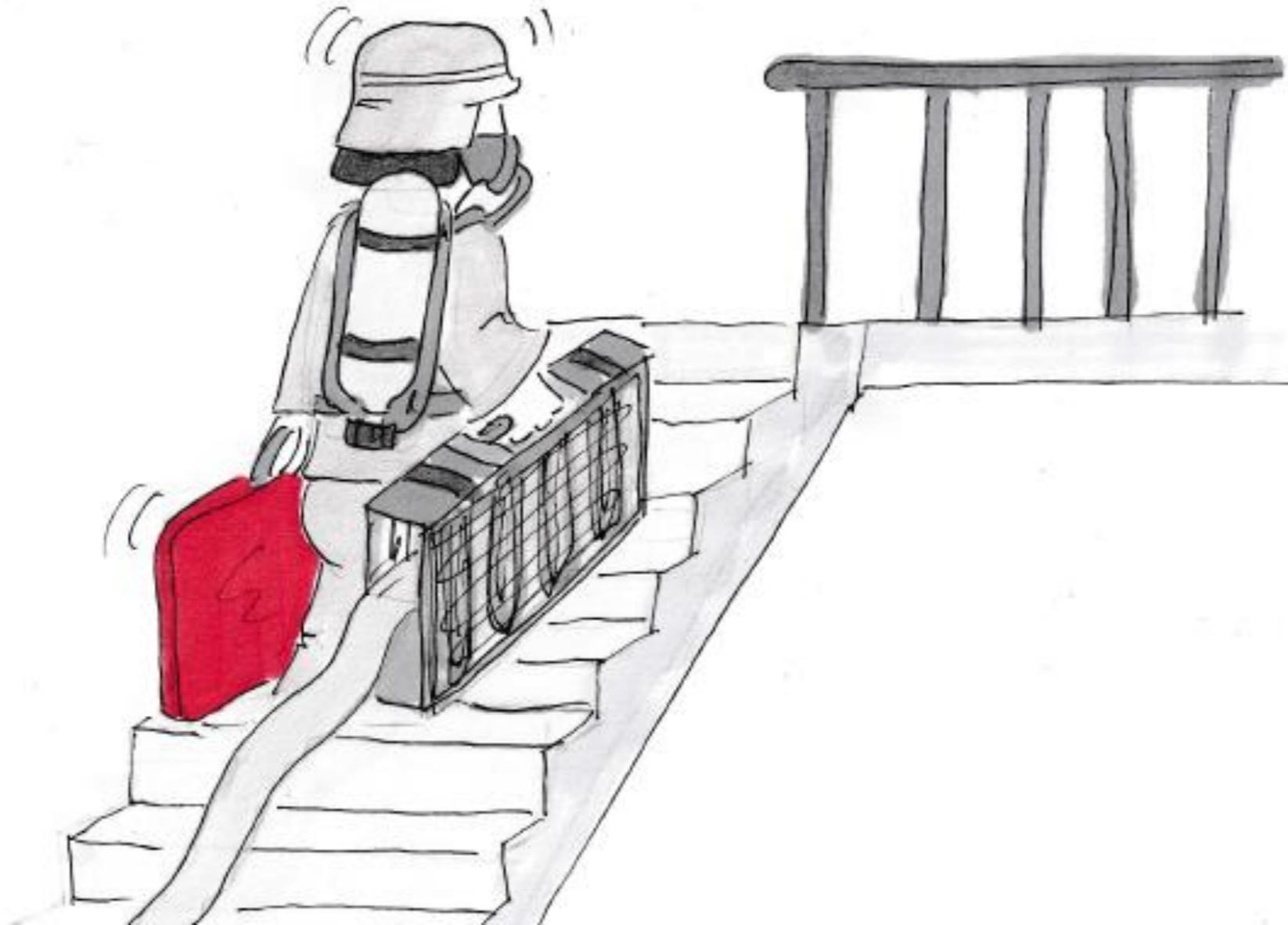
Du kannst die Schlauchleitung auf der Treppe verlegen. Es gilt dabei der Faustwert, dass man zur Überwindung eines Geschosses einen C-Schlauch benötigt.
