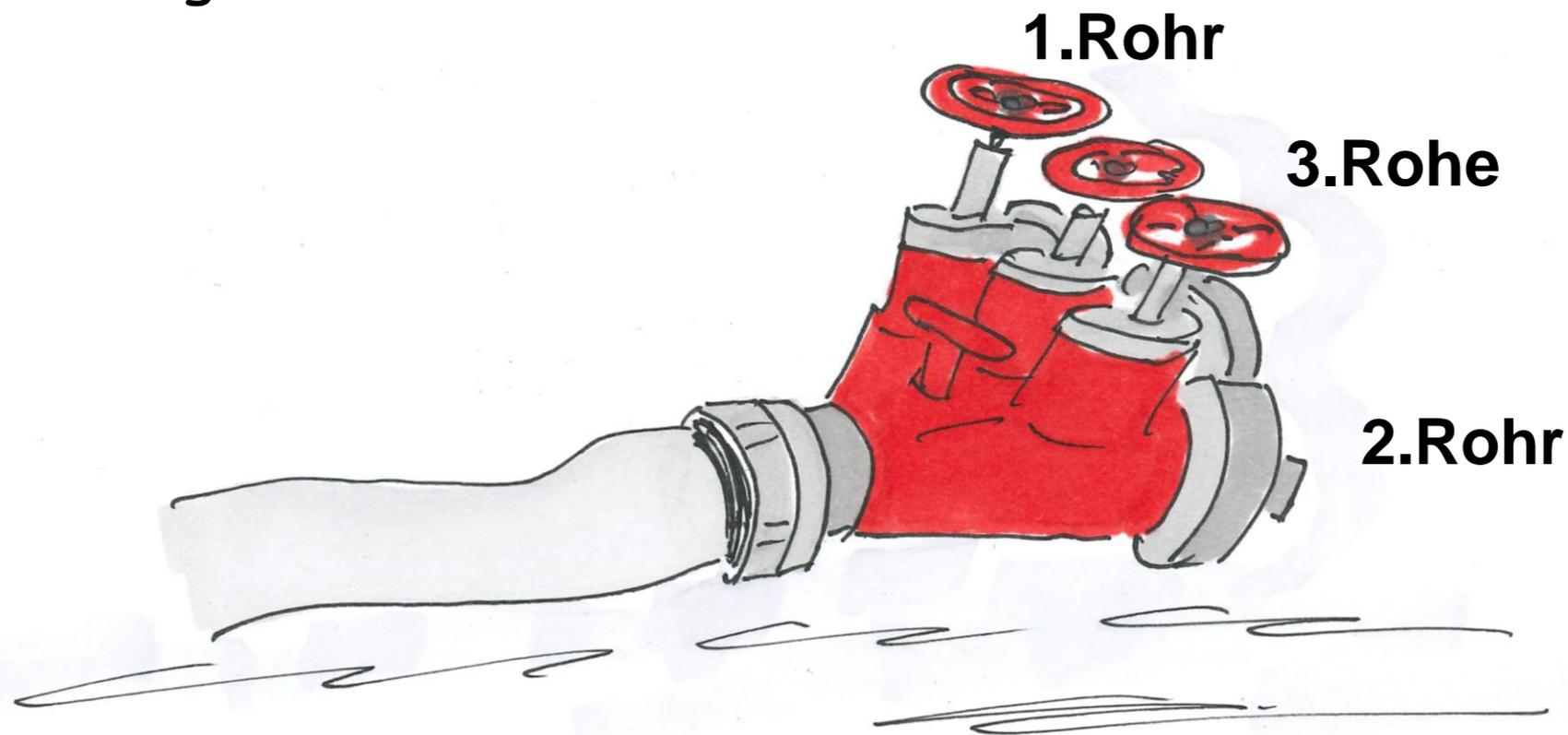
Das Rohr am linken Abgang in Fließrichtung heißt das „1.Rohr“, das am rechten Abgang heißt „2.Rohr“ und in der Mitte ist das „3. Rohr“.
