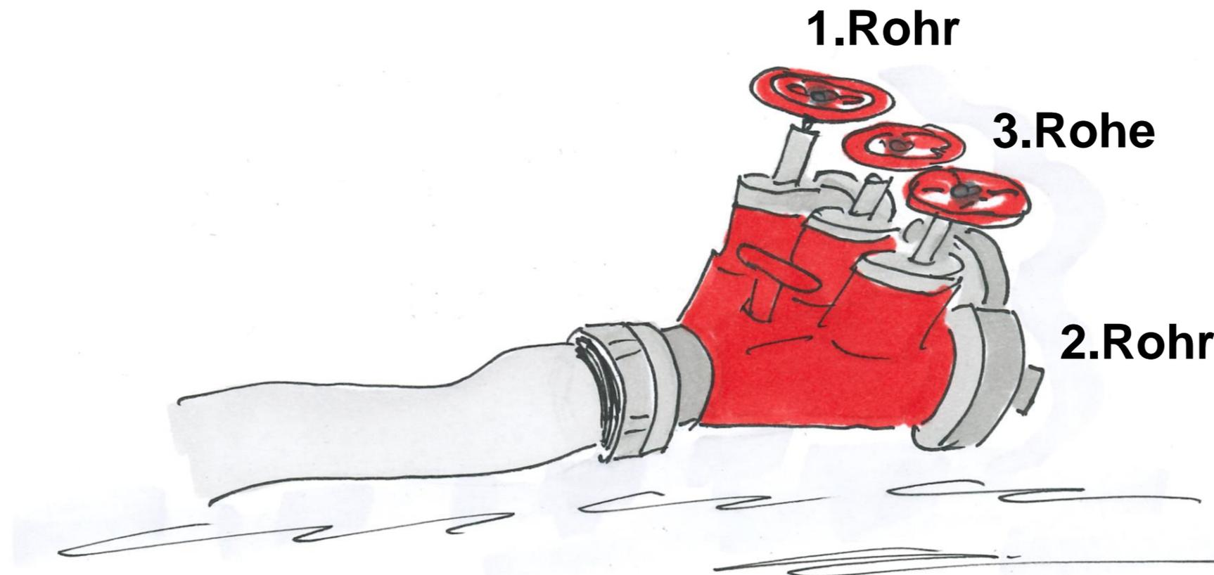
Für eine eindeutige Kommunikation wird das Rohr am linken Abgang in Fließrichtung als „1.Rohr“ bezeichnet, das am rechten Abgang als „2.Rohr“ und in der Mitte ist das „3. Rohr“.
