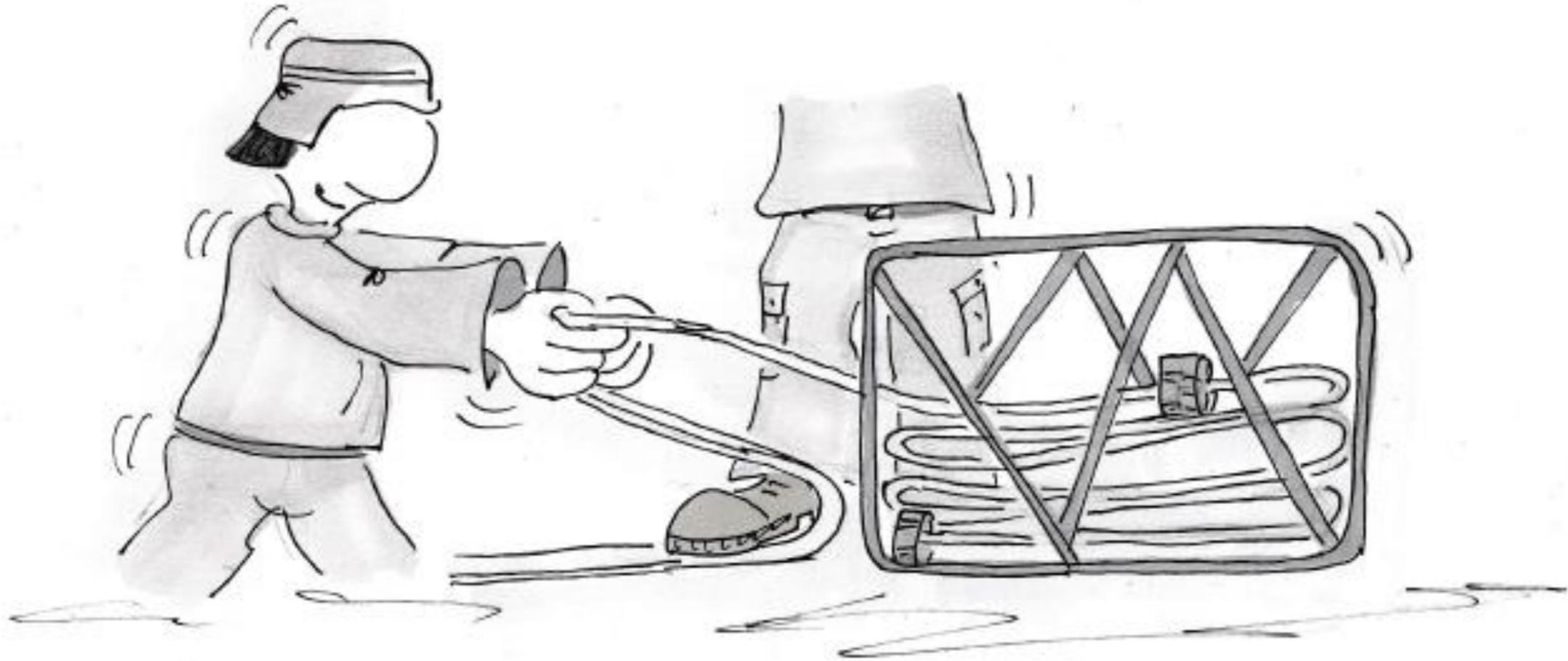
Der andere greift sich den Schlauch aus dem Korb locker mit beiden Händen, lässt ihn beim Rückwärtsgehen durch seine Hände gleiten und verlegt so den Schlauch in Buchten.
