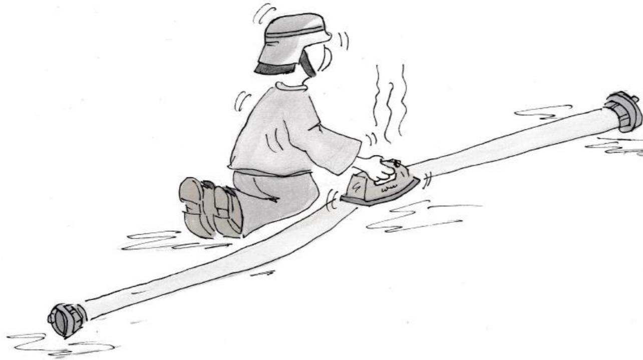
Sonst kann es, wenn Druck auf die Leitungen gegeben wird, zu einem unkontrollierbaren Herumwirbeln der Verteilers kommen oder sich sogar Kupplungsverbindungen wieder lösen.
