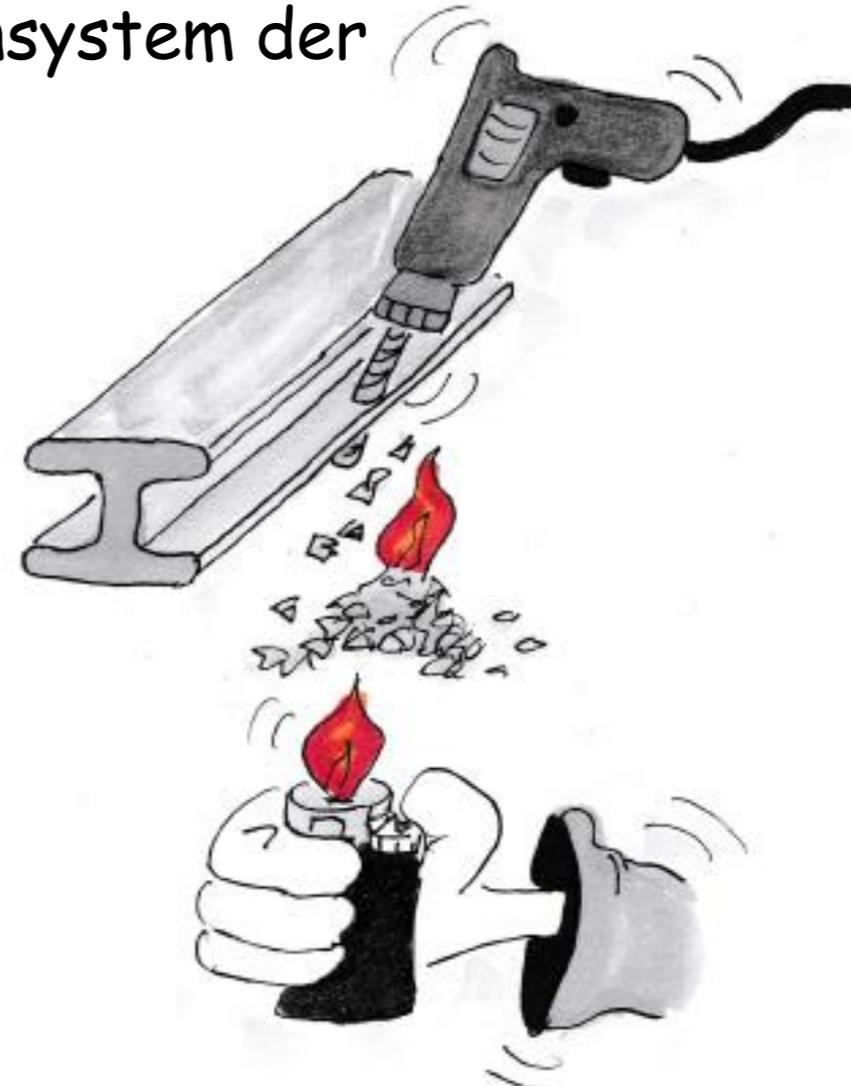
Das klassische Eisen brennt sicherlich nicht als kompakter Stahlträger, sondern nur in einer feinen Form von Stahlwolle oder Schleifstäuben (z.B. in Absauganlagen der metallverarbeitenden Industrie)
