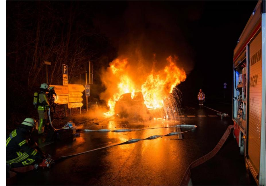
In modernen Fahrzeugen werden Bauteile aus Magnesium und Aluminium verbaut, die bei ausgedehnten Bränden, mit hohen Temperaturen, auch an der Verbrennung teilnehmen.
