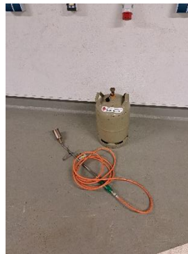
Gasbrenner zum Erhitzen der Übungsgasflasche
