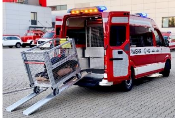
Abbildung 8: Foto Mannschaftstransportwagen der Feuerwehr Nürnberg mit einem dem zu entwickelnden Fahrzeug ähnlichen Verlastungssystem (Rixner, BF Nürnberg).
