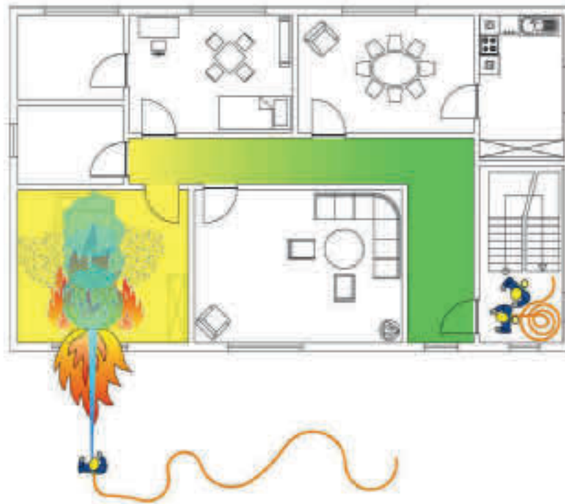
Abbildung 19 - Positive Verschiebung der Gefahrenbereiche bei offener Brandraumtür und offenem Fenster als Ventilationsöffnung durch Fensterimpuls mit Vollstrahl von außen - Strahl wandert von vorne nach hinten, Jürgen Buil
