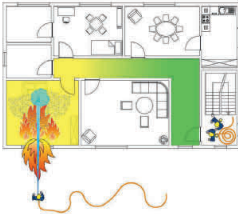
Abbildung 17 - Positive Verschiebung der Gefahrenbereiche bei offener Brandraumtür und offenem Fenster als Ventilationsöffnung durch Fensterimpuls mit Vollstrahl von außen (Sprinkler-Effekt), Jürgen Buil
