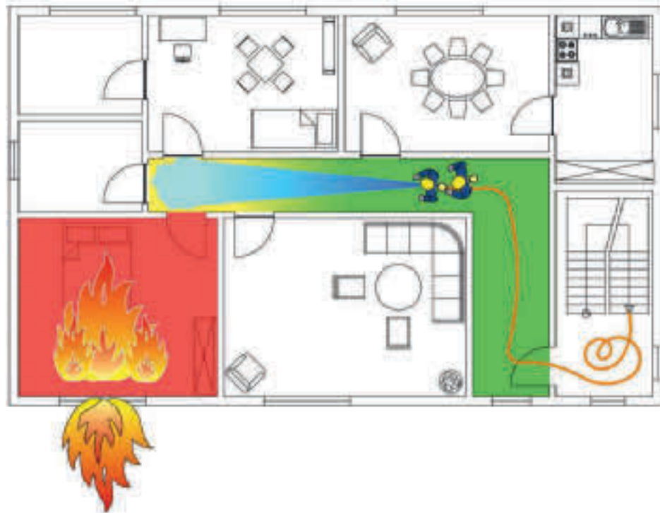
Abbildung 21 - Positive Verschiebung der Gefahrenbereiche bei offener Brandraumtür und offenem Fenster als Ventilationsöffnung durch Rauchgaskühlung (längere Wasserabgabe), Jürgen Buil
