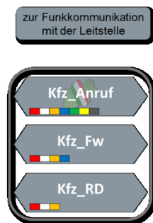
Abbildung 5: Regionale TMO-Rufgruppen zur Funkkommunikation mit der Leitstelle. Die farbigen Kästchen zeigen eine Rufgruppenberechtigung für Feuerwehr (rot), Rettungsdienst (weiß), Katastrophenschutz (orange), THW (blau), Polizei (grün), Luftfahrzeuge (gelb) und Ordnungsämter (dunkelgrau) an. Das NRW-Emblem im Hintergrund symbolisiert landesweite Nutzbarkeit.
