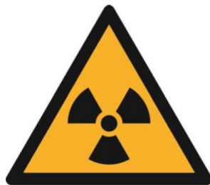
Abbildung 23: Warnzeichen W003 nach ASR A1.3 [ASR 1.3], „Warnung vor radioaktiven Stoffen oder ionisierender Strahlung“
