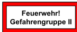
Abbildung 26: Kennzeichnung der Gefahrengruppe IIA [FwDV 500]
