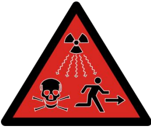
Abbildung 24: Warnhinweis vor radioaktiven Stoffen nach IAEO [ISO 21482], eingeführt im Jahr 2007, darf nur zusammen mit Warnzeichen W003 (Abbildung 23) verwendet werden.
