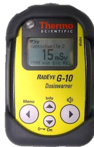
Abbildung 40: Dosiswarner Thermo Fisher Scientific RadEye G-10 [Bild: IdF NRW]
