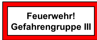
Abbildung 39: Kennzeichnung GG IIIA nach FwDV 500 (Anlage 4)
