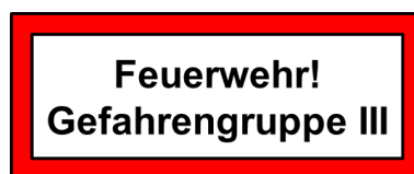
Abbildung 39: Kennzeichnung GG IIIA nach FwDV 500 (Anlage 4)
