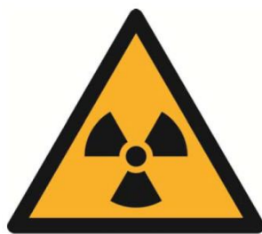
Abbildung 23: Warnzeichen W003 nach ASR A1.3 [ASR 1.3], „Warnung vor radioaktiven Stoffen oder ionisierender Strahlung“
