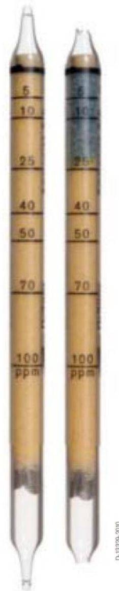
Abbildung 45: Prüfröhrchen Ammoniak 5/b (Dräger-Röhrchen & CMS-Handbuch, 17. Auflage, März 2015)
