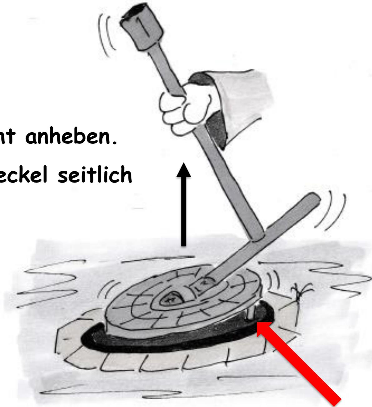
Der Deckel ist über einen Stift (roter Pfeil) fixiert und kann nur um Stiftlänge senkrecht herausgehoben. und um die Achse des Stiftes gedreht werden.
