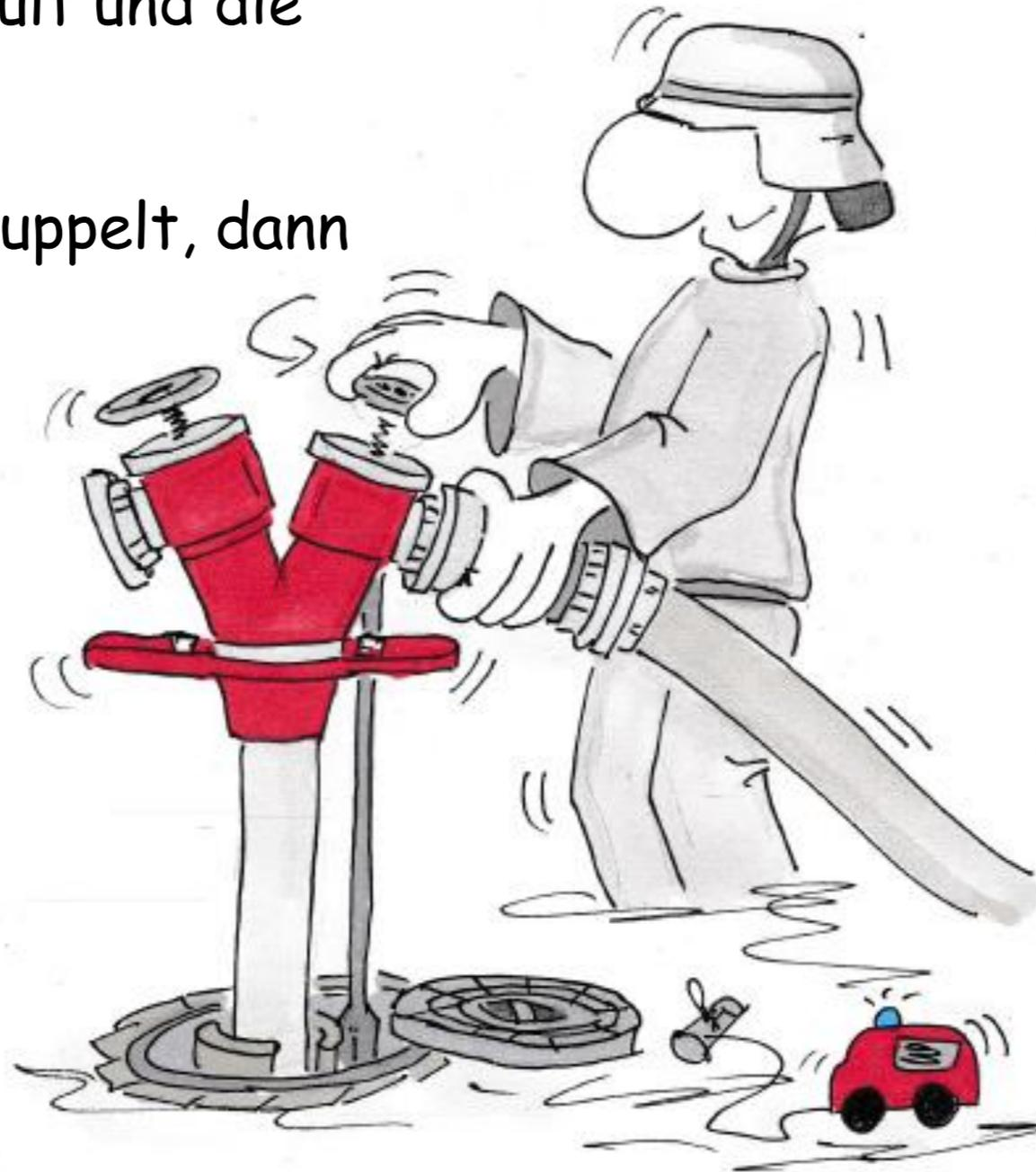
Bevor du „Wasser-marsch“ gibst, vergewissere dich, ob der Maschinist die B-Leitung am Fahrzeug angekuppelt hat und gib ihm ein Signal, dass nun Wasser kommt.
