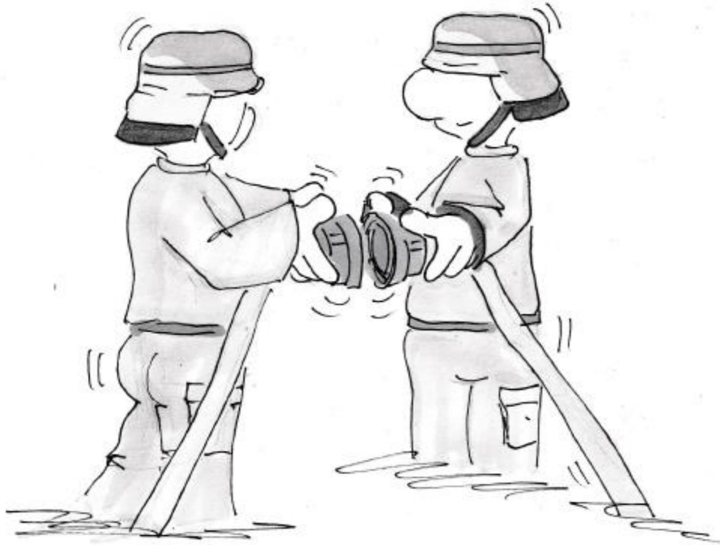
Die Kupplungen sind oft schwergängig und es ist wichtig, dass sie bis zum Endanschlag gedreht werden, damit sie sich nicht lösen.
