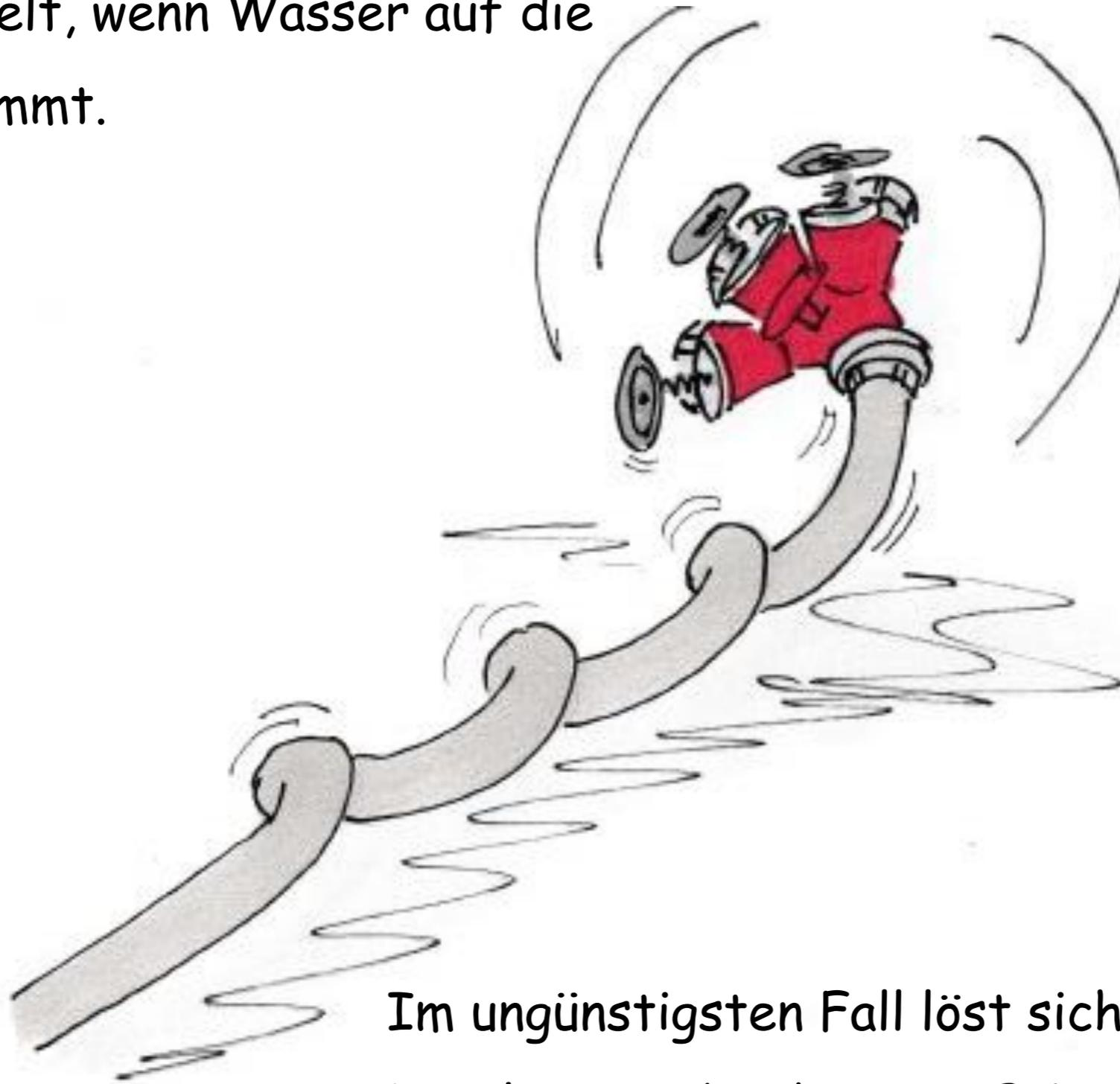
Im ungünstigsten Fall löst sich die Kupplungsverbindung von B-Leitung und Verteiler und der B-Schlauch schlägt unkontrolliert umher.
