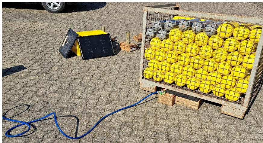
Bild IdF NRW 2025 - Einschubhöhe des Hebekissens durch Unterbau reduzieren
