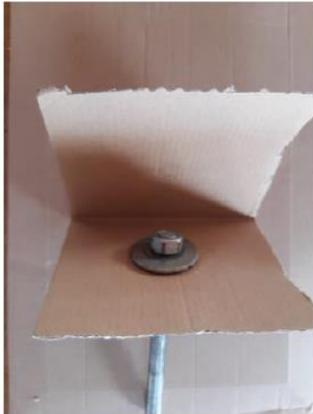
Befestige eine Gewindestange mit Mutter und Unterlegscheibe an einer doppelagigen und stabilen Pappe.
