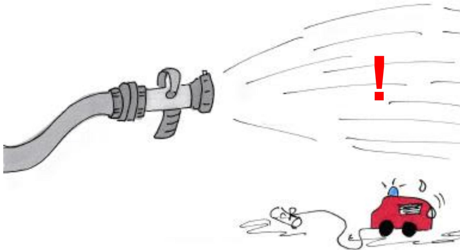
Auf manchen Hohlstrahlrohren steht die zulässigen Spannungen und die entsprechenden Abstände drauf.
