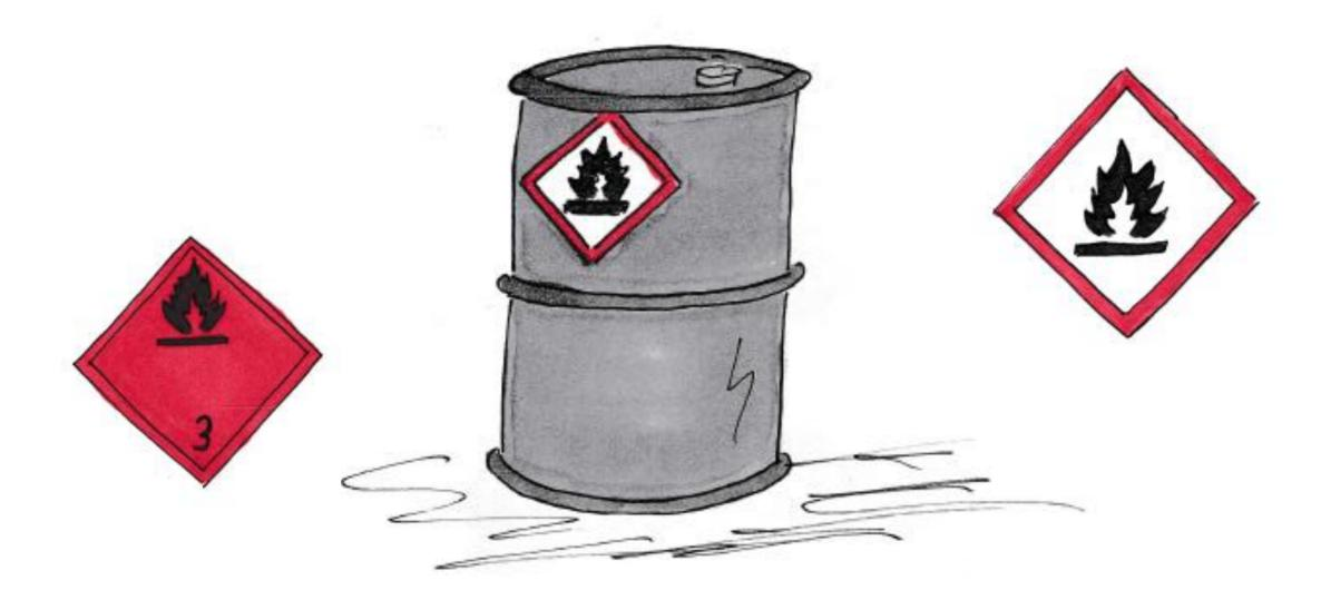
In früheren Kennzeichnungssystemen gab es Hinweise auf die Temperatur des Flammpunktes. Das wurde geändert. Es gibt nur noch den Hinweis, dass die Gefahr der Brennbarkeit existiert.
