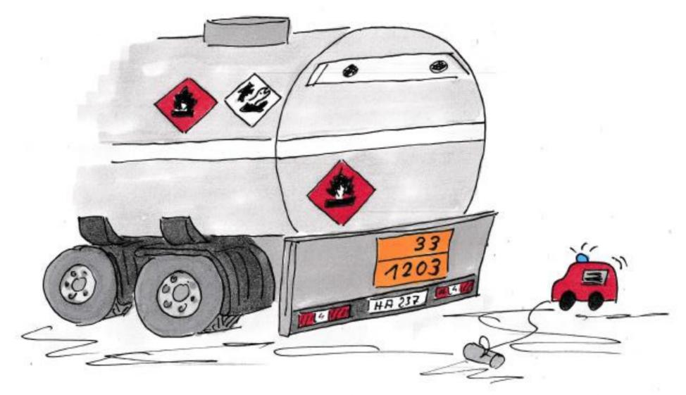
33 Gefahr der Brennbarkeit einer Flüssigkeit mit einem Flammpunkt unter 23° C
