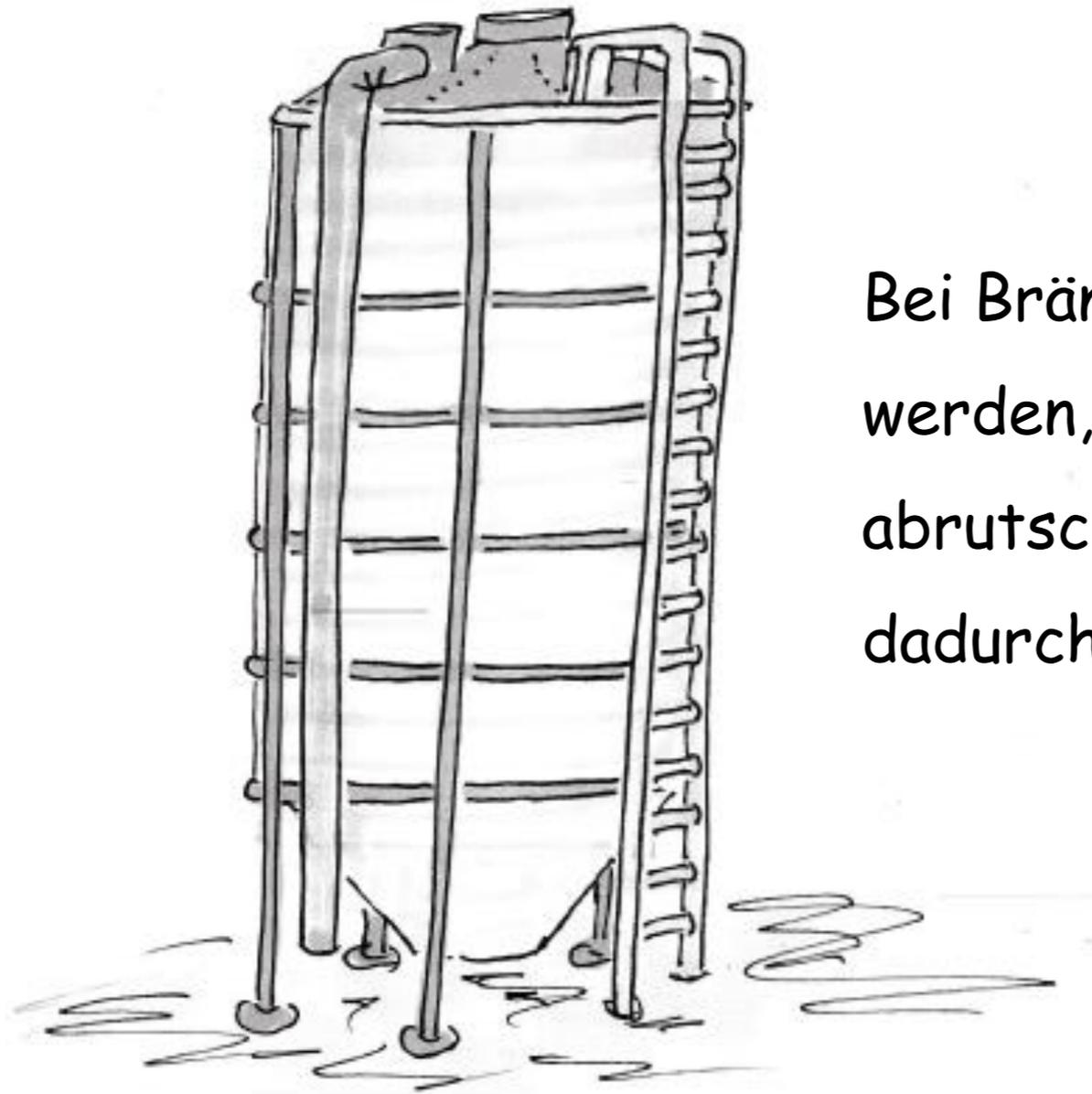
Bei Bränden in Silos muss verhindert werden, dass Teile des Lagergutes abrutschen und nachrutschen. Es würde dadurch dann Staub aufgewirbelt.
