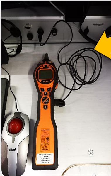
Schließen Sie das Gerät mit dem separatem USB-Schnittstellenkabel (1) an einem der USB-Ports oder (besser) separaten PC an.
