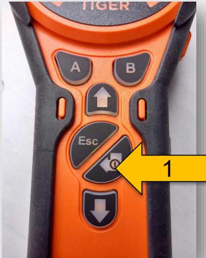
Nach dem betätigen der EIN/AUS-Taste (1) wird eine Überprüfung der UV-Lampe (2) und
