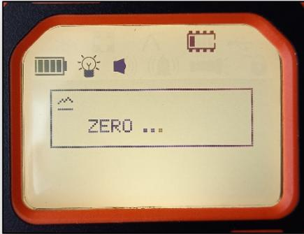
Der Nullabgleich muss an sauberer Umgebungsluft durchgeführt werden.
