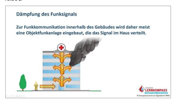
Man verbaut an solchen Gebäuden daher oftmals Objektfunkanlagen, die das Funksignal im gesamten Gebäude und dem unmittelbaren Außenbereich verteilen.
