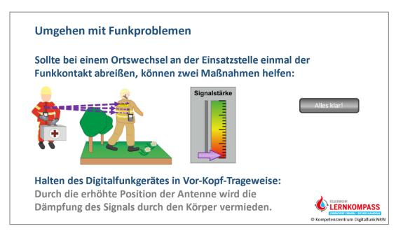
Wenn sich der Sender (ganz gleich ob Basisstation oder ein anderes im DMO arbeitendes Digitalfunkgerät) hinter dem empfangenden HRT befindet, liegt der Körper der betreffenden Einsatzkraft direkt in dem Weg, den das Funksignal zurücklegen muss. Da es dadurch also zusätzlich abgeschwächt werden kann, könnte dies bei ohnehin geringer Signalstärke den Funkkontakt abreißen lassen.
