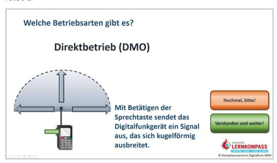
Das Signal wird dabei gleichmäßig rund um die Antenne ausgesendet, sodass es sich (annäherungsweise) kugelförmig ausbreitet.
