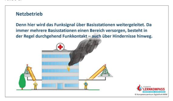
Im Netzbetrieb (TMO) wird der Funkverkehr über Basisstationen abgewickelt, wobei mehrere Basisstationen aus unterschiedlichen Richtungen einen Bereich abdecken. Dadurch besteht im Netzbetrieb meist auch hinter großen Hindernissen (z.B. Gebäuden oder Hügeln) Funkkontakt.
