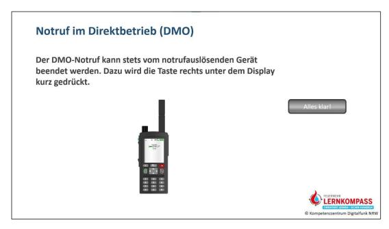
• Sollte die Notruffunktion versehentlich ausgelöst worden sein, kann diese einfach gelöscht werden, indem die Taste rechts unter dem Display gedrückt wird.
