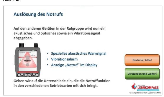
Wenn die Notruffunktion ausgelöst wurde, erhalten sowohl das notrufauslösende Gerät als auch alle anderen Digitalfunkgeräte in Sendereichweite und der gleichen Rufgruppe eine Information darüber, dass ein Notruf ausgelöst wurde.
